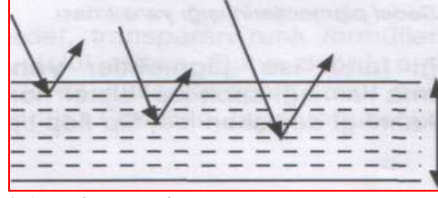
Resim 2.1 Alüminyum pigmentlerden ışığın yansımaları
