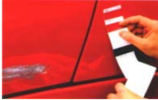
Resim 1.4: Test plakası ile orijinal araç boyasının kontrolü
