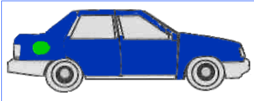
Resim 1.9:Astarlı bölge P 600 ile zımparalanır.
