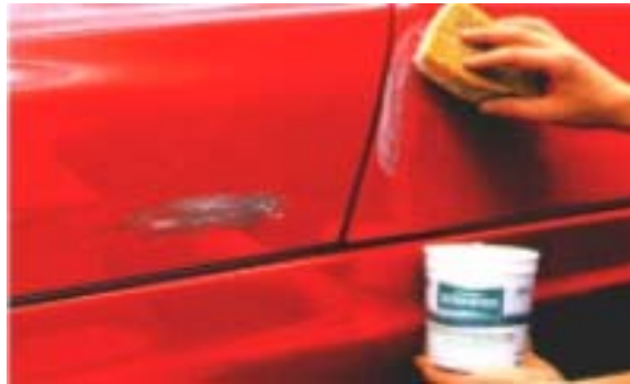
Resim 1.2:Renk kontrolü için yüzeye pasta-poliş işlemi yapılır.
