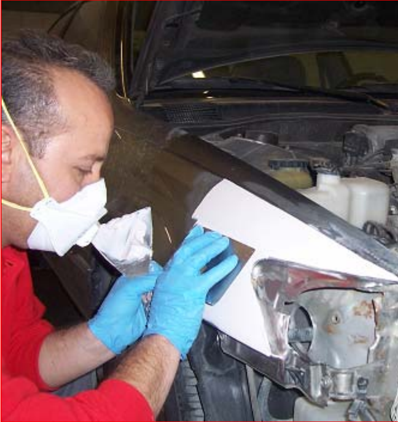
Resim 3.3: Macun dolgu işleminin yapılması
