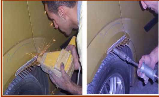
Resim 2.5: Perçin kaynatarak düzeltme
