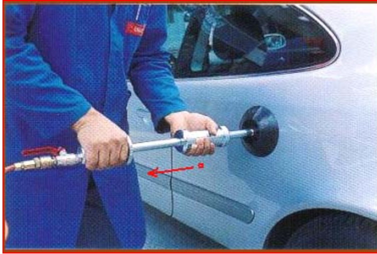
Resim 1.2: Vakumlu pnömatik çekirme cihazı ile araç panel onarımı
