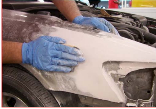
Resim 4.4: El ile zımparalama
