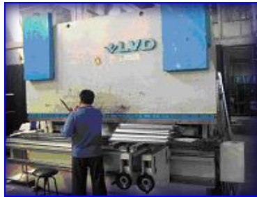
Resim:1.7: Abkant presle bükme işlemi
