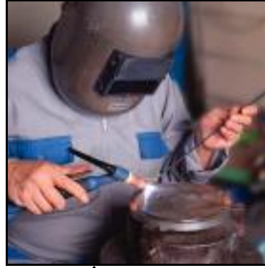
Şekil 1.7: TİG kaynağının yapılışı
