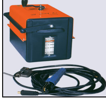
Şekil 1.2 : Transformatör tipi kaynak makineleri
