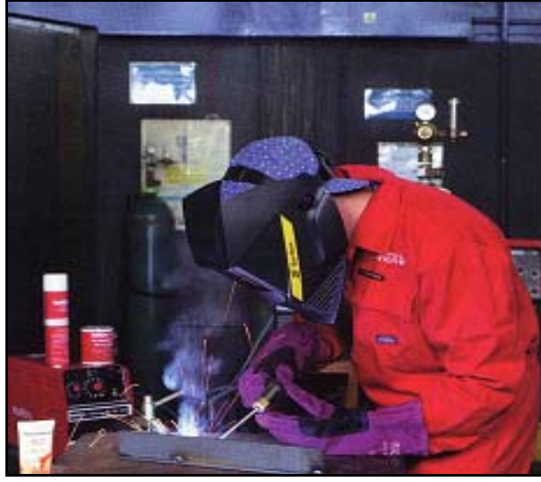
Şekil 1. 19: Ark oluşumu ve elektrot örtüsünün kaynak bölgesini koruması
