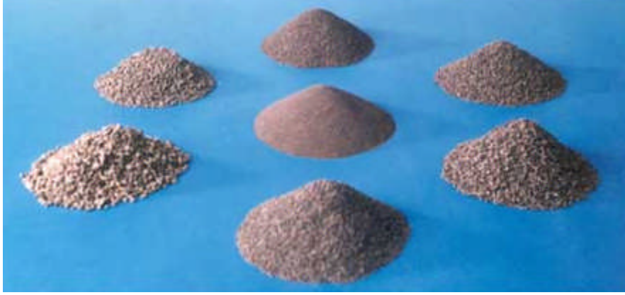
Şekil 7.2: Zımparayı oluşturan değişik özellikte kum tanecikleri
